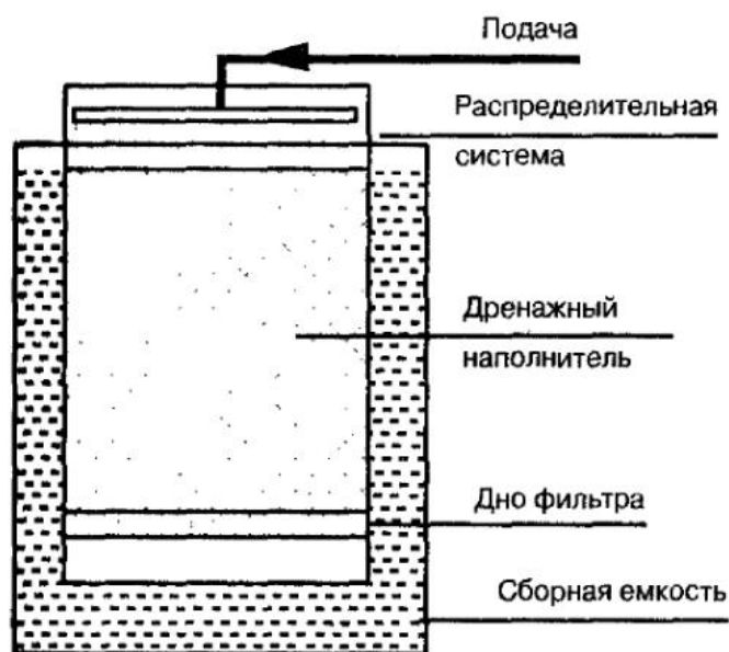
Принцип погружного биофильтра
