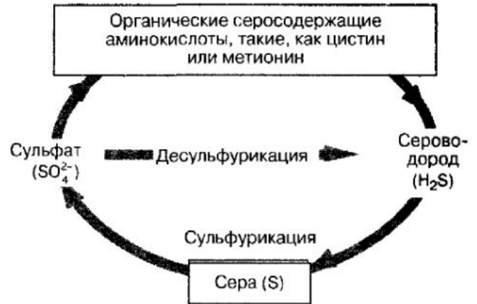
Образование сероводорода анаэробными бактериями: процесс крайне нежелательный для аквариума
