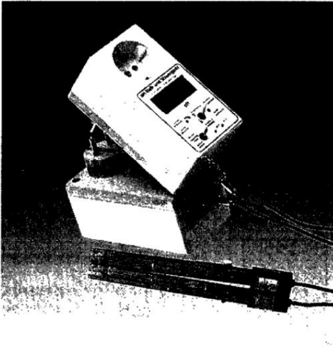
Прибор измеряет значение pH и регулирует включенный магнитный вентиль через штепсельную розетку
