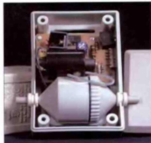
► Современные озонаторы – компактные приборы. В нижней части этой модели находится камера, где на воздух действует высоковольтный разряд и вырабатывается озон.
