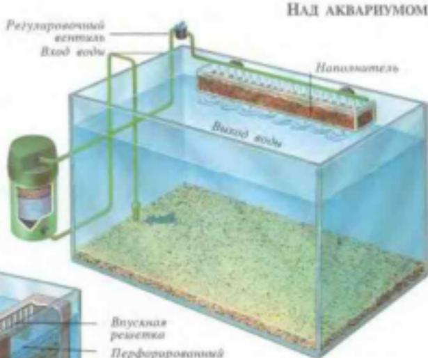
Внутренний фильтр с орошением можно оборудовать неподвижным, угловым фильтром и даже декон赖以生存izing фильтром. Эта фильтрация намного предпочтительнее простых моделей только с биологической очисткой.
